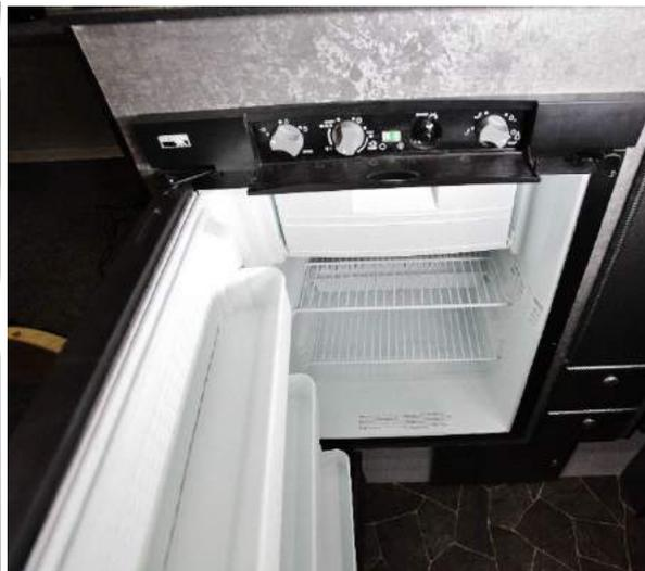
Auch Absorber-Kühlschränke können auf Wunsch verbaut werden. Dies geschieht aber in der Regel bei uns in Deutschland damit der Absorber für die Netzspannung keinen zusätzlichen Transformator von von 230V auf amerikanische 110V benötigt.
