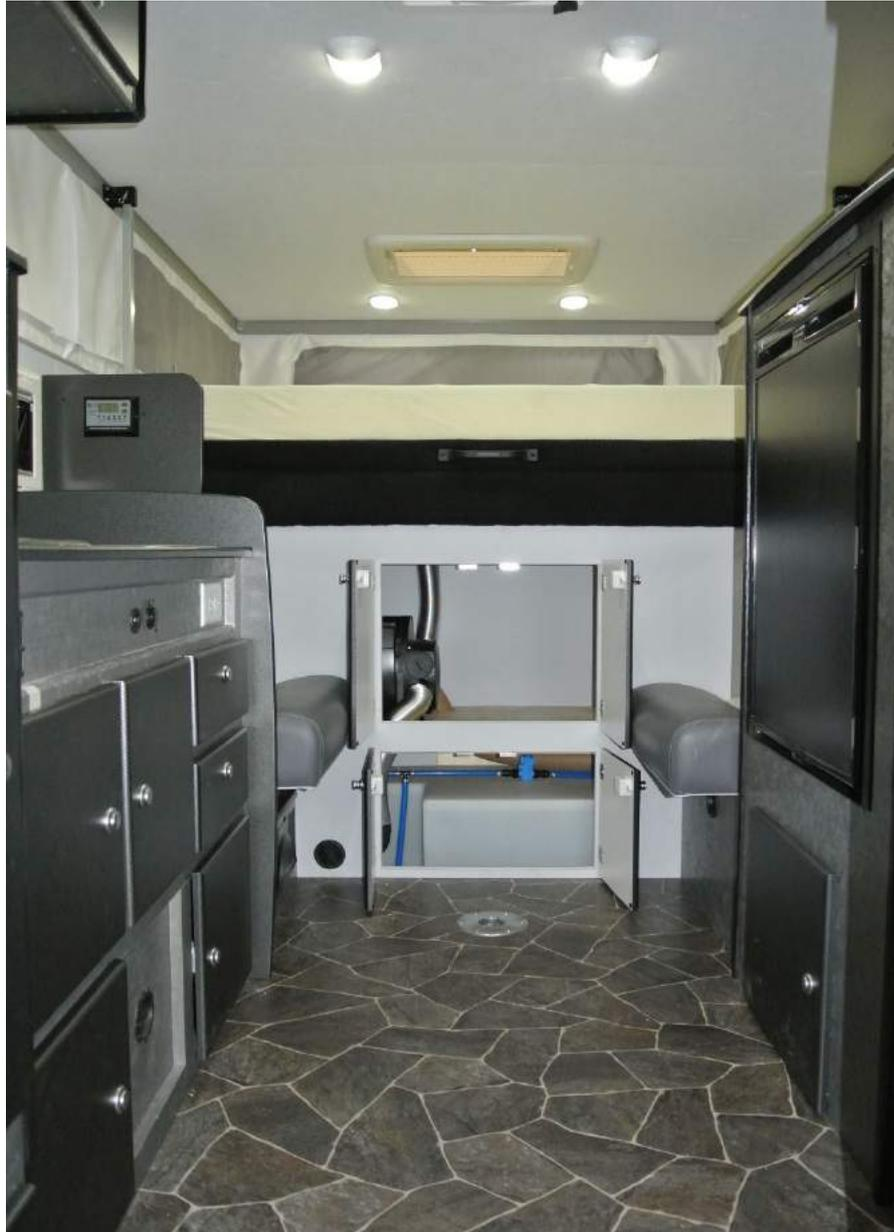
Blick in den vorderen Stauraum mit Frischwassertank unten und Truma C4 Heizung oben
