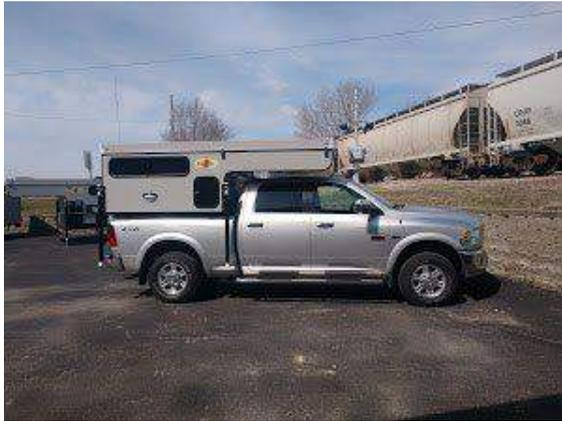
Das **Bundutec BushBaby** passt mit 193 cm Bodenlänge perfekt auf Amerikanische Shortbed Pickup wie RAM 1500 oder Ford F-150 mit 6.5ft Ladefläche. Auf einem in Europa gebräuchlichen 1,5 Kabiner schließt diese Wohnkabine bündig mit der Heckstoßstange ab was uneingeschränkte Anhängertauglichkeit garantiert. Sie eignet sich durch ihre hervorragende Gewichtsverteilung auch sehr gut für Doppelkabiner-Pickup. Durch die solide Offroad-taugliche Bauweise liegt Ihr Trockengewicht bei ca. 643 kg.
